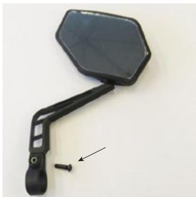
Supporto di montaggio con bullone M5 x 18 mm a testa tonda. Coppia = 2-2,5 Nm
