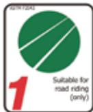
El uso previsto de todos los modelos es ASTM CONDICIÓN 1, Carretera de alto rendimiento.
