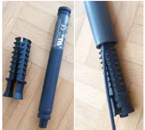
Empuje la batería Di2 y la funda dentro la tija del sillín. Asegúrese de que el cable de la luz trasera esté colocado dentro de la ranura. Una vez que el conjunto de la batería esté completamente insertado en la tija, puede tirar levemente del cable para ajustar el sobrante de cable de la parte superior.
